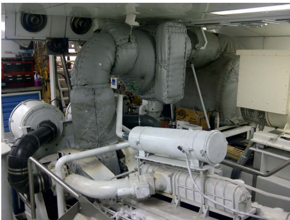
Purificador oxocatalítico de unos de los motores propulsores
