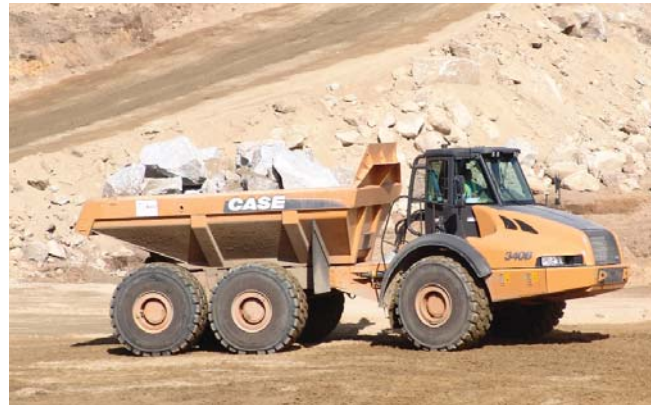
Los dúmperes CASE 340B en tareas de carga y transporte en las obras de la Tercera Ronda de A Coruña.
